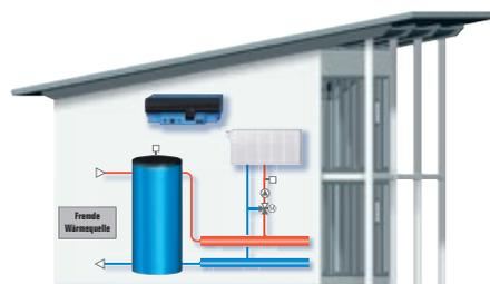
Logamatic 4323 quale regolatore autarchico del circuito riscaldamento con funzione di controllo dell'alimentazione di calore, anche in caso di fonti di calore esterne.
