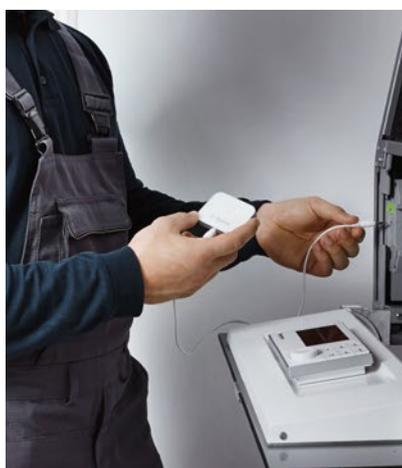
Kabel einstecken, Smart Service Key per Magnethalterung ans Gerät anklicken und über die App ProWork relevante Daten auslesen – Service vor Ort so schnell wie noch nie.
