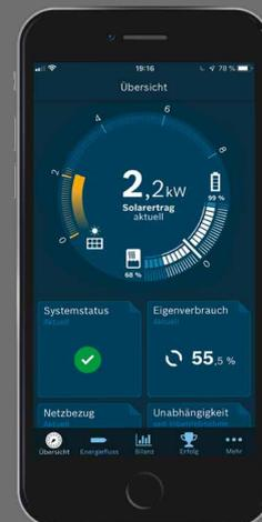
Wichtige Informationen schnell parat: Visualisierung von aktueller Photovoltaik-Produktion, Ladezustand der Batterie und des Trinkwarmwasserspeichers sowie des aktuellen Systemstatus.
