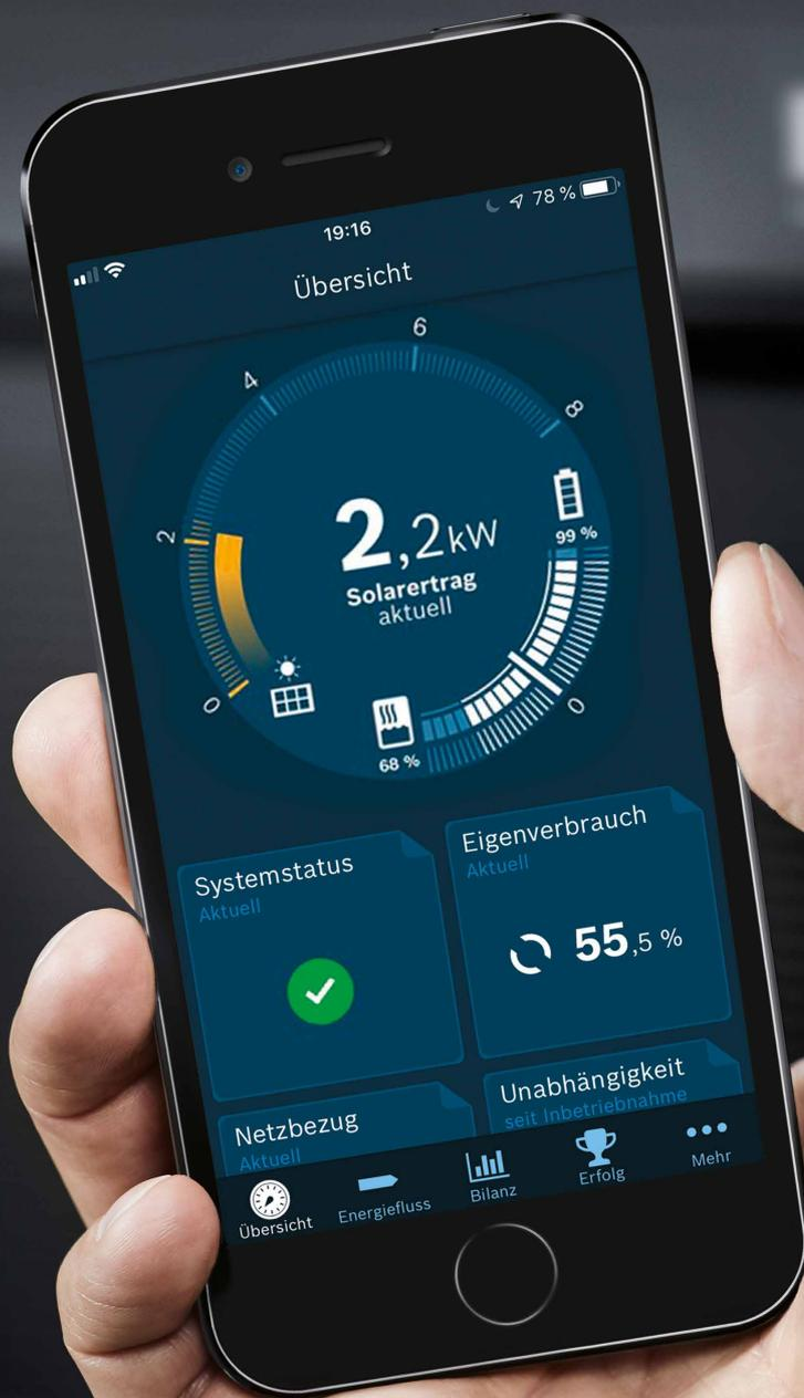
Mit dem Energiemanager von Buderus können die Erträge der Photovoltaik-Anlage in Kombination mit einer Buderus Wärmepumpe optimal genutzt werden: zur Steigerung des Eigenstromverbrauchs und für mehr Unabhängigkeit von Energieversorgern. Zudem visualisiert der Energiemanager die Energieflüsse und den Verbrauch im Haushalt.
