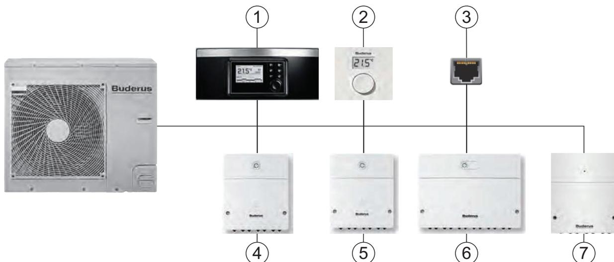
[1] Module de commande Logamatic HMC310
