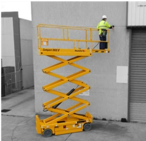
**Remarque :** il est important que l'AWP soit placé sur une surface stable et plane. Sinon, en cas de déséquilibre, l'AWP se mettra en sécurité et la hauteur ne pourra pas être atteinte.
