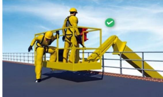
Une nacelle à ciseaux ne peut pas être utilisée pour accéder à un toit plat ou à une plate-forme. Ce type de nacelle élévatrice vise à effectuer des travaux en hauteur contre les murs.
